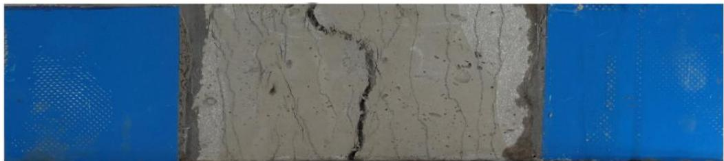
(d) Failure of ECC
