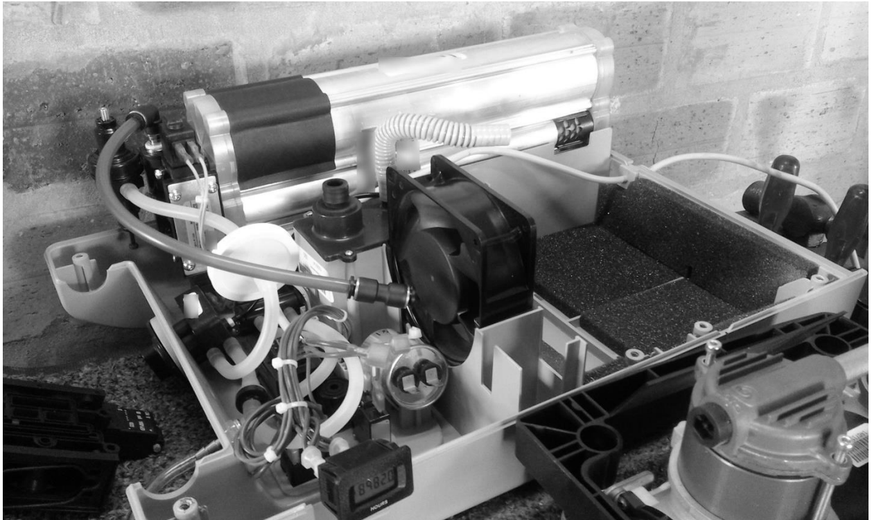
Figura 7: El interior de un concentrador de oxígeno. El reloj que cuenta las horas de funcionamiento también es visible. Foto de la autora
